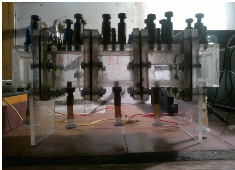
სურათი 7. საწვავი ელემენტის ლაბორატორული მოდელი
