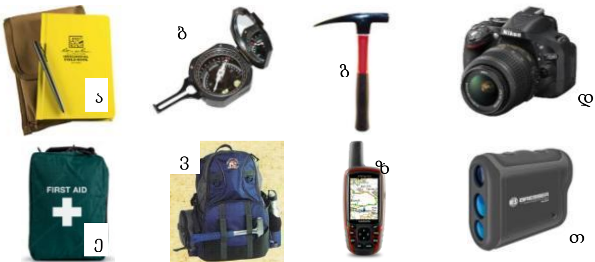
სურ. 8. კვლევებისთვის საჭირო ძირითადი აღჭურვილობა: ა) საველე დღიური; ბ) გეოლოგიური კომპასი; გ) გეოლოგიური ჩაქუჩი; დ) ციფრული ფოტოაპარატი; ე) პირველადი დახმარების ჩანთა ვ) საველე ზურგჩანთა; ზ) GPS; თ) დურბინდი-მანძილმზომი
