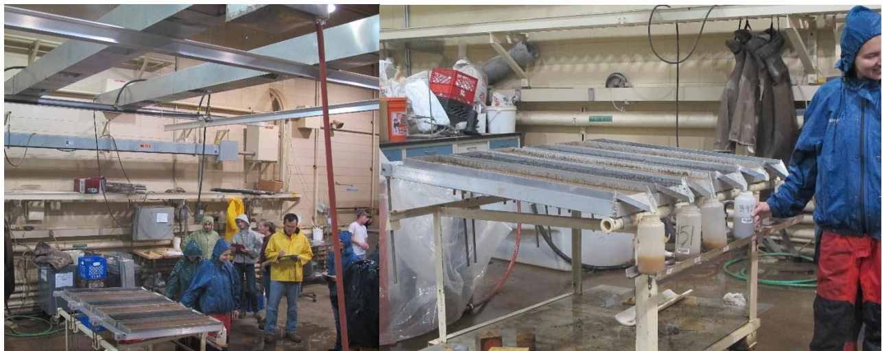
ფოტო 10. წვიმის სიმულატორი (National Soil Erosion Research Laboratory, Perdue University)
