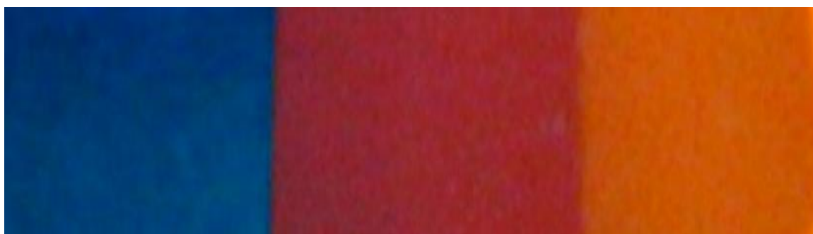
სურათი 32. ტემპერატურის განაწილება ვერცხლის წყლის ნათურით დასხივების დროს, t=0 დროის მომენტისათვის ნიმუშს აქვს ლურჯი ფერი, t=6 წუთი მოწითალო-მოყავისფრო ფერი, t=12 წუთის შემდეგ მონარინჯო-მოყვითალო ფერის.
