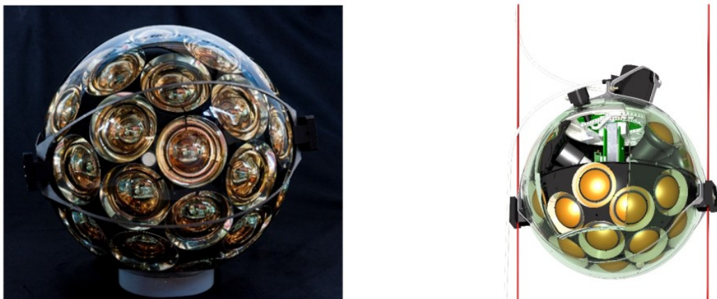
სურათი 2.14. მარცხნივ ოპტიკური მოდულის ფოტო. მარჯვნივ დეტექციის ერთეულზე დამონტაჟებული ოპტიკური მოდულის კომპიუტერული გრაფიკული სურათი
