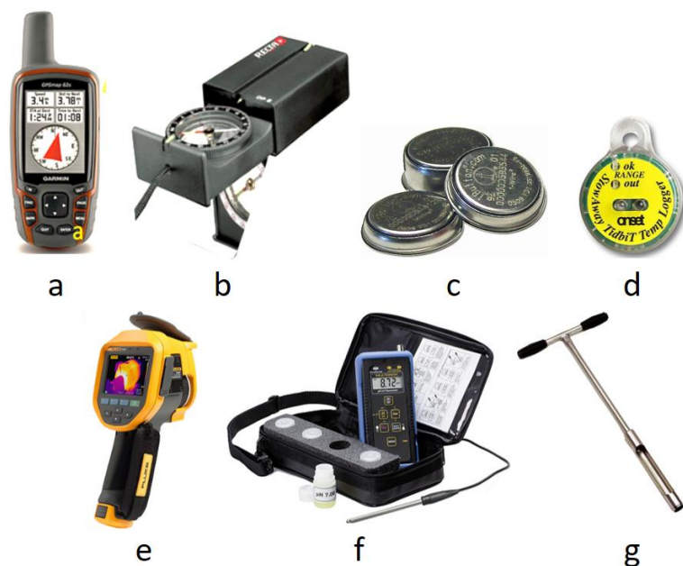
ნახ. 9. კვლევაში გამოყენებული ხელსაწყო-აპარატურა: a – GPS, b – კომპას-კლინომეტრი, c და d – ტემპერატურის ავტომატური მინილიგერები, e – თერმოსკანერი, f – pH-მეტრი, g – ნიადაგის ნიმუშის ასაღები ბურღი
