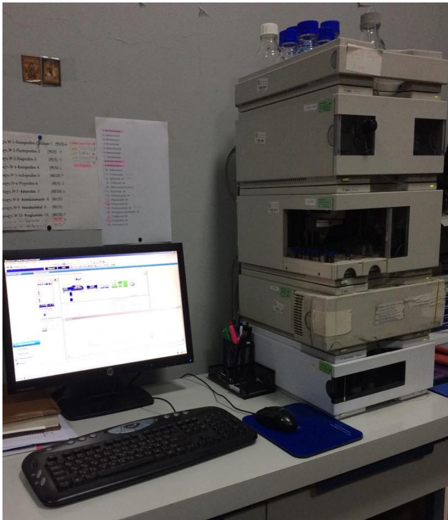
სურათი 10. Agilent 1200 სერიის მაღალეფექტური სითხური ქრომატოგრაფი
