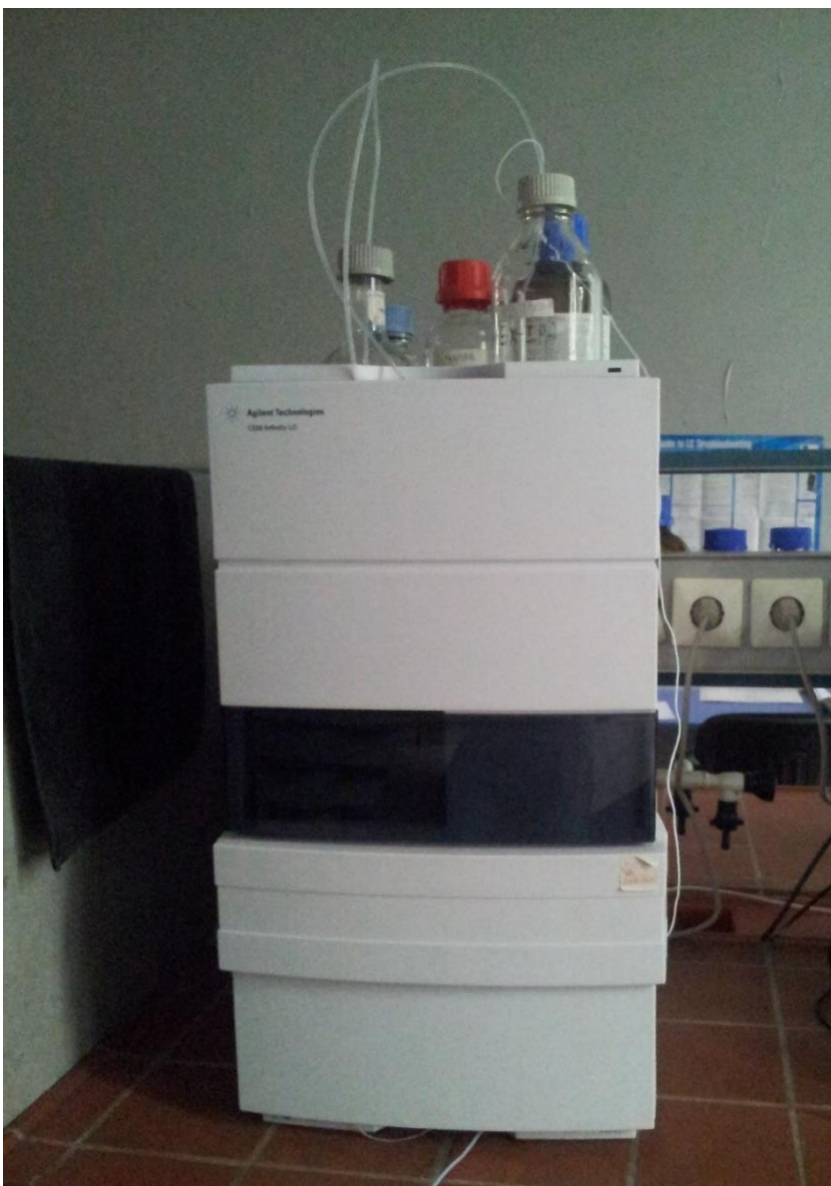
სურათი 11. Agilent 1220 სერიის მაღალეფექტური სითხური ქრომატოგრაფი
