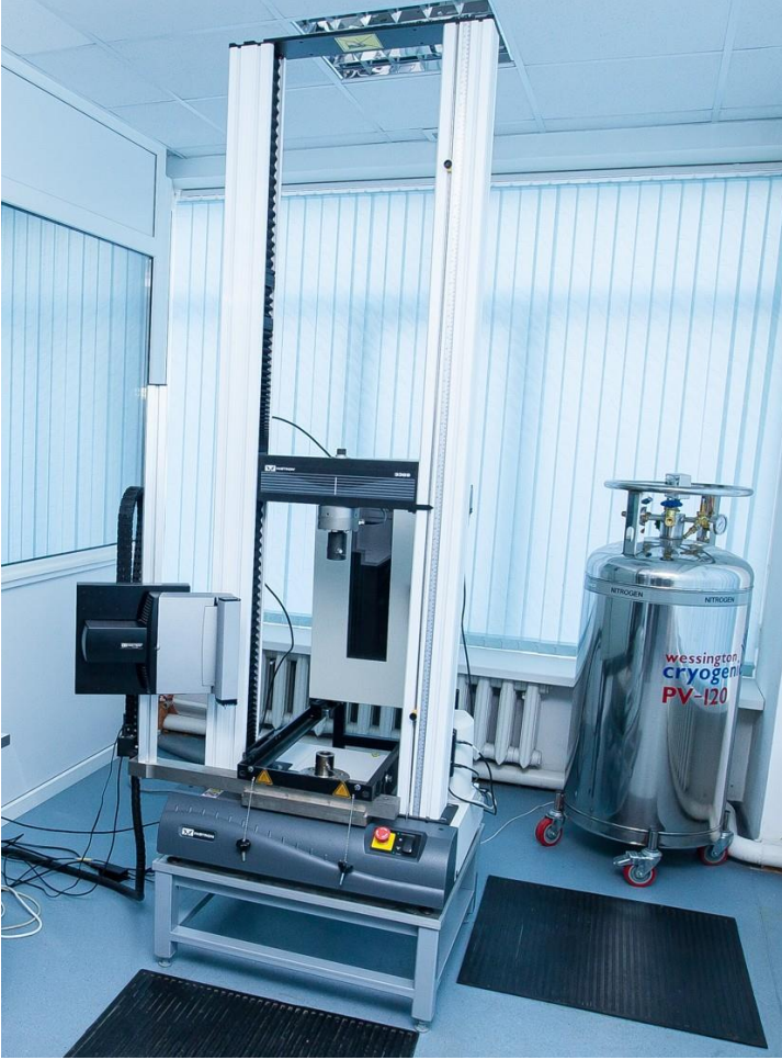
სურ.1. Instron 3369, უნივერსალური მექანიკური სატესტო დანადგარი, რომელზეც განხორციელდა კვლევები
