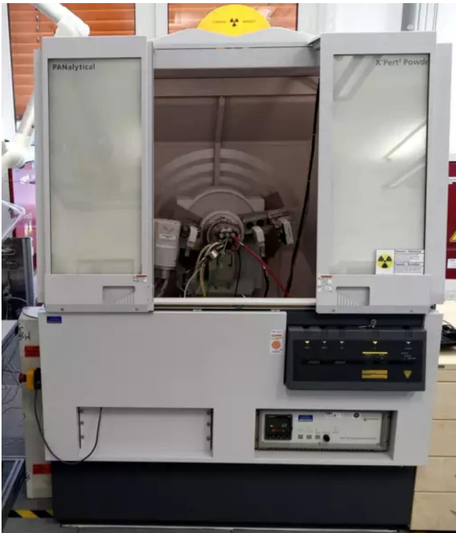
სურ. 3. X'Pert MRD Pro, დიფრაქტომეტრი, რომელზეც განხორციელდა კვლევები
