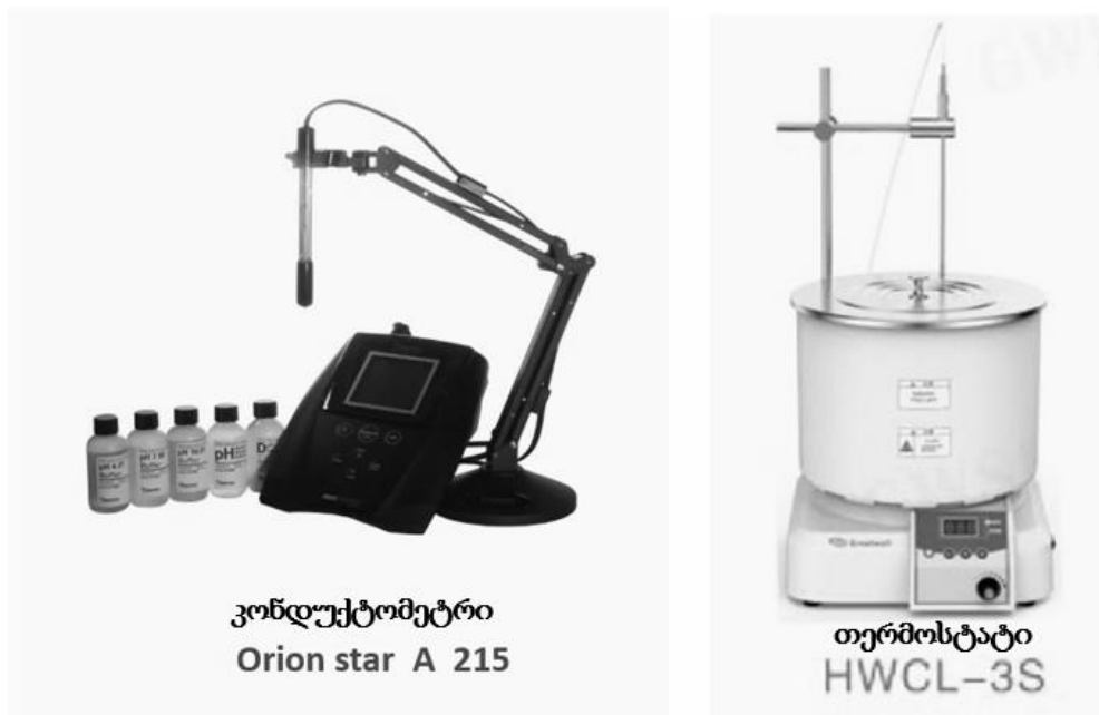
ნახაზი 14. გამოყენებული ხელსაწყოები: კონდუქტომეტრი და თერმოსტატი
