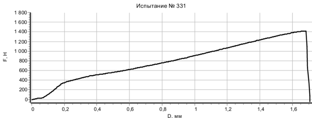
სურათი 19. გაჭიმვის კვლევის შედეგი I (TESst 3%, 180°C) კომპოზიტისთვის - ძალისა და დეფორმაციის დამოკიდებულება
