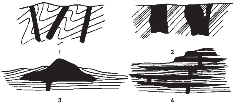
სურ. 3.8. ინტრუზიული სხეულები 1 – დაიკი, 2 – ნეკი, 3 – ლაკოლითი, 4 – შრეძარღვი (სილი) (Короновский, Якушова, 1991)
