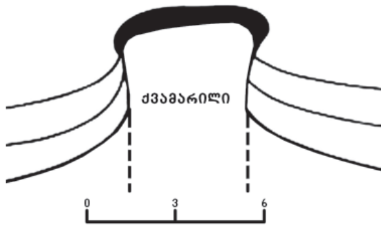
სურ. 3.15. დიაპირული ნაოჭი (Аллисон, Палмер, 1984)
