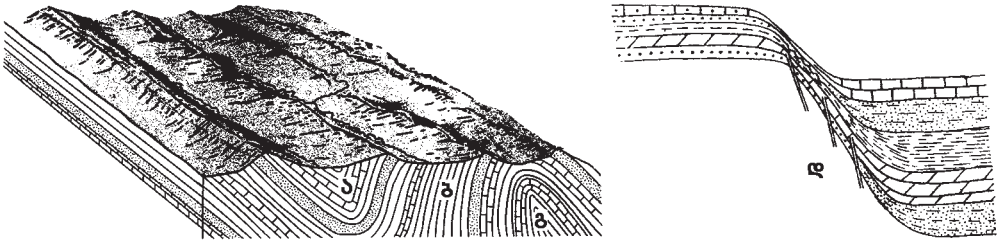
სურ. 3.12. ნაოჭა სტრუქტურები: ა – სინკლინი, ბ – მონოკლინი, გ – ანტიკლინი, დ – ფლექსურა (Аллисон, Палмер, 1984)
